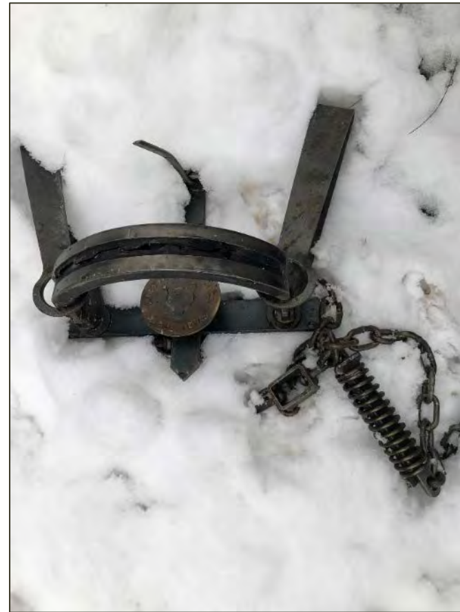
Soft-Catch-Trap EZ Grip No. 7 (gepolsterte Fußfalle)
