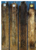
Prüfkörper im Bodenbohrkern
