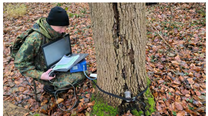
Abb. 3: Messung flüchtiger organischer Verbindungen mit der elektronischen Nase PEN3 an einer Esche (Bild: Henriette Häuser)
