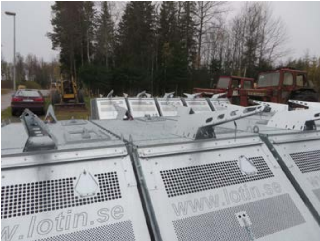
Abb. 24: Über zwei Schieber im Fallendach und je eine Öffnung im oberen Bereich der Falltür erfolgt die Erlegung der gefangenen Wildschweine
