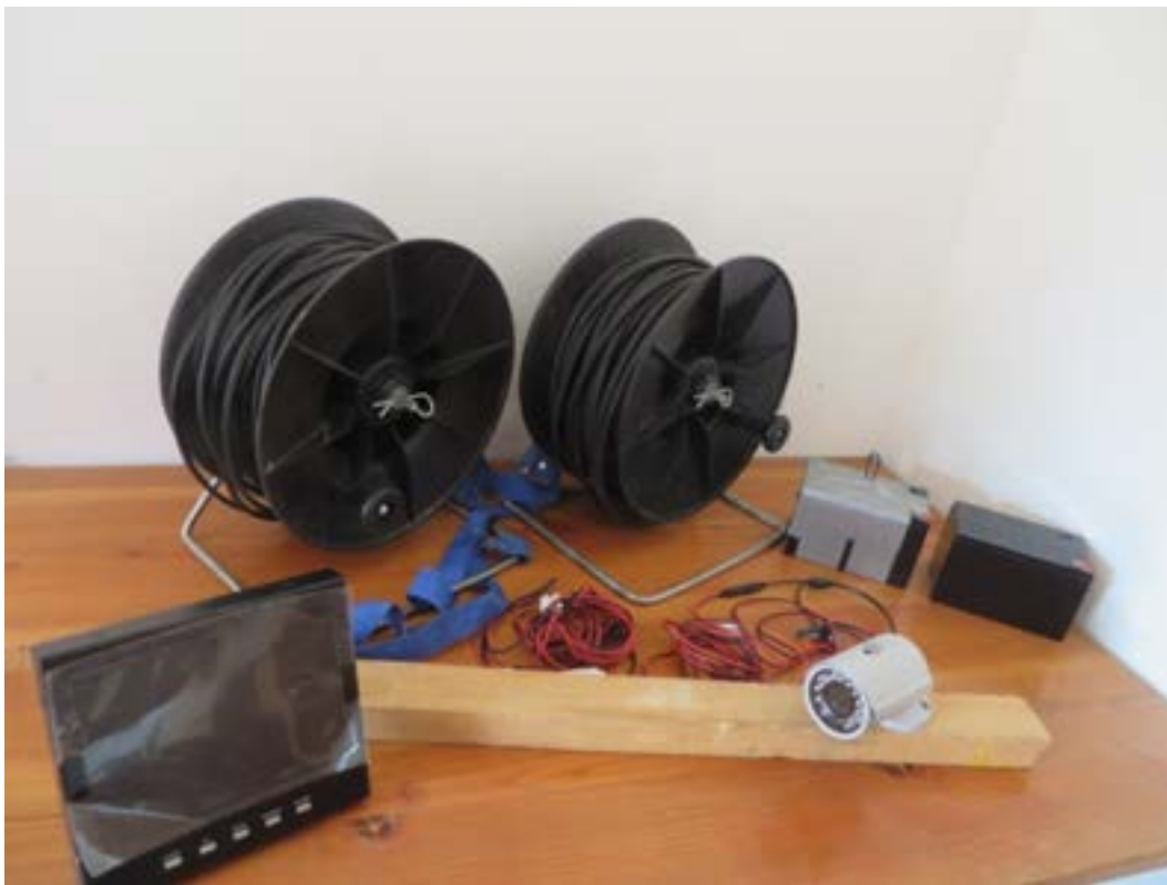
Abb. 21: Fangüberwachung über Kabelverbindung (max.100 m), IR-Kamera, 2 Batterien (Kamera, Monitor), Monitor und Verbindungskabel
