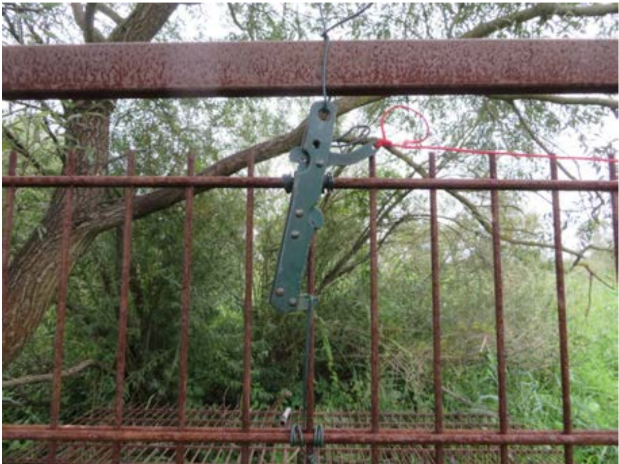
Abb. 3: Auslösemechanismus und Zugleine zur Auslösung
