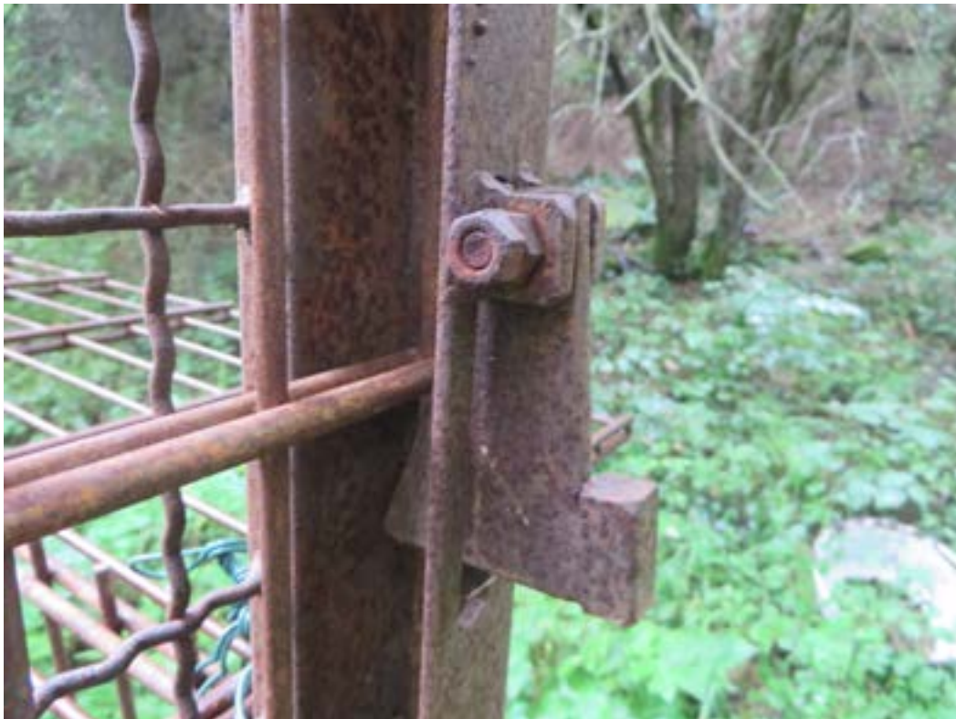
Abb. 14: Durch die Montage einer Falltorsicherung wird beim Fang von stärkerem Schwarzwild das Ausheben der Falltür mit dem Gebräch unterbunden
