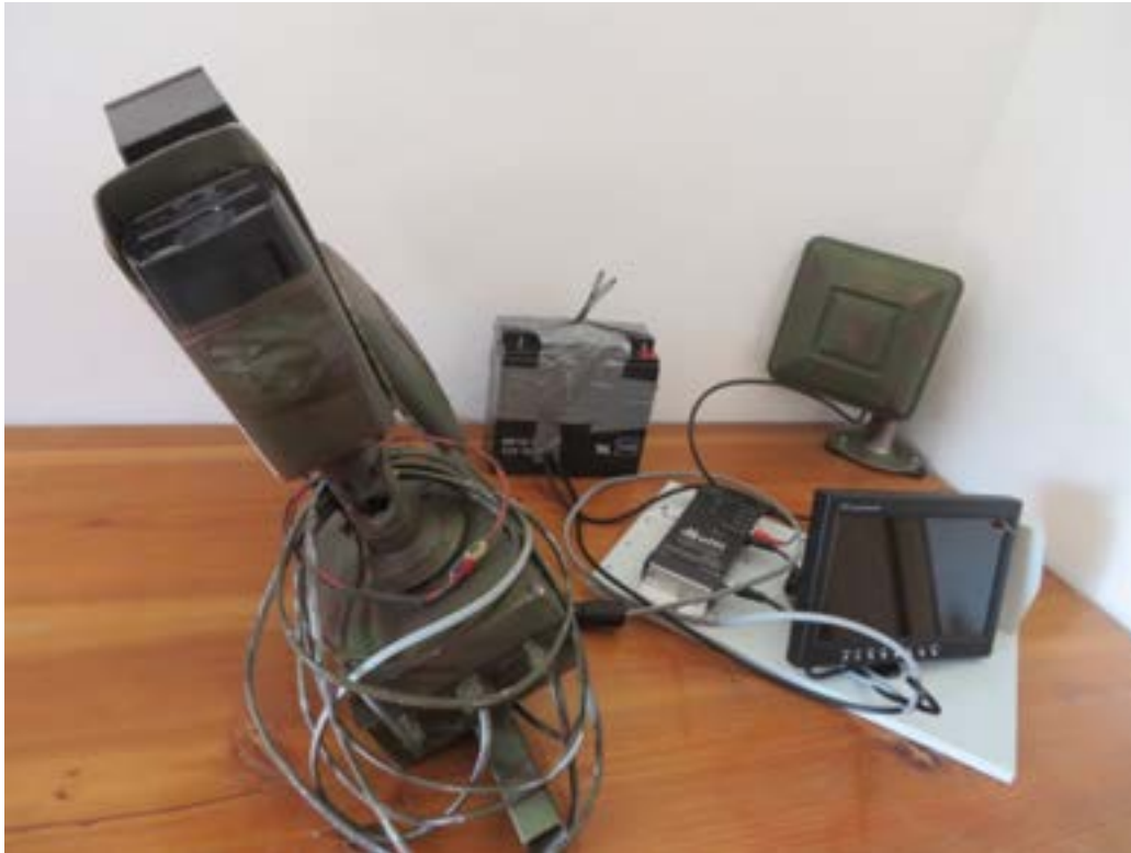
Abb. 22: IR-Funkkamera, Batterie, Empfänger und Monitor mit Steuerteil
