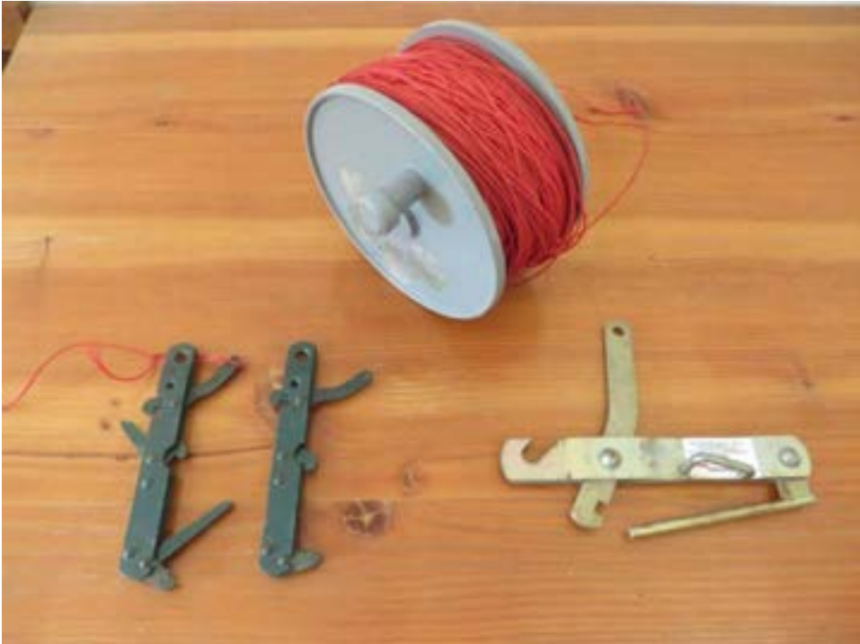
Abb. 18: Auslösemechanismus (verschiedene Ausführungen) der Falltür mit Auslöseleine, der komplette Auslösemechanismus sollte nur an der Falle angebracht sein, wenn gefangen wird
