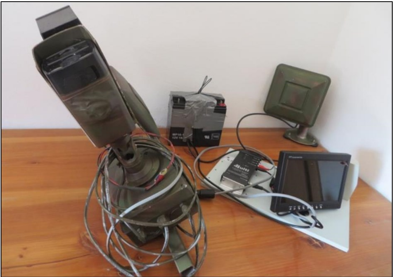
Abbildung 46: System zur Bildübertragung mittels lokaler Funkstrecke (Foto Dr. E. Gleich)
