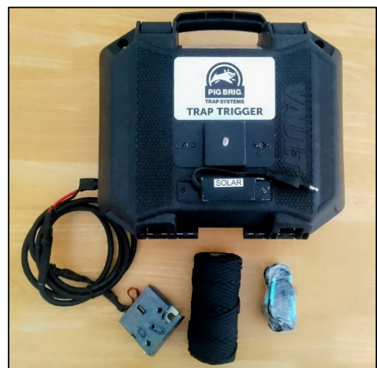
Abbildung 55: Kommerzielles Angebot eines Fangauslösers mit GSM-Controller und elektrischem Schloss.
