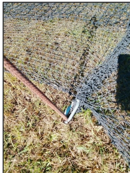
Abbildung 20: Der Netzanker wird durch die am Netz befestigte Karabineröse gesteckt und ermöglicht so ein Einwechseln des Schwarzwildes in den Fang (Foto: Dr. C. Gremse).
