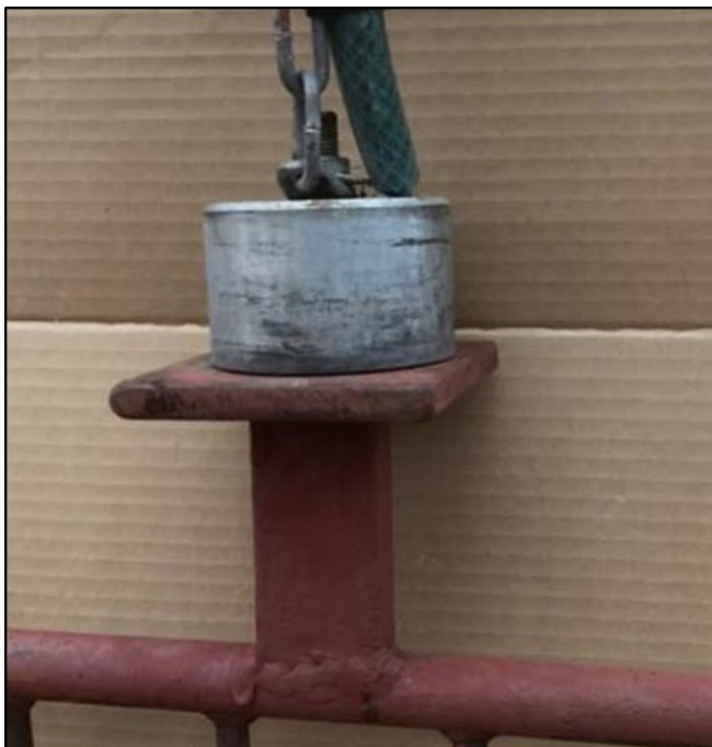
Abbildung 52: Magnet mit anhaftender Aufnahmeplatte und Falltor. Der Magnet hängt höhenverstellbar an einer Kette, die elektrische Leitung ist in dem Schlauch geschützt geführt (Foto: Dr. Jörg Melzheimer)
