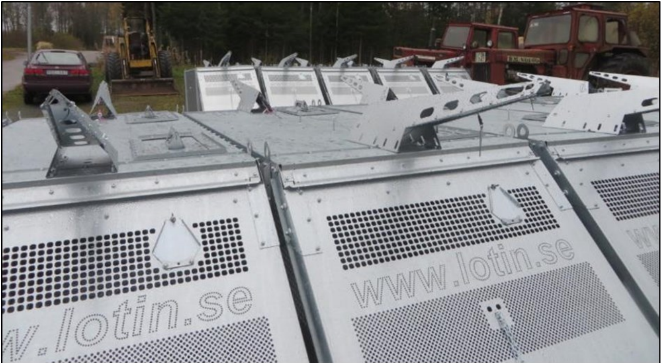
Abbildung 30: Über zwei Schieber im Fallendach und je eine Öffnung im oberen Bereich der Falltür erfolgt die Erlegung der gefangenen Wildschweine (Foto: Dr. E. Gleich)
