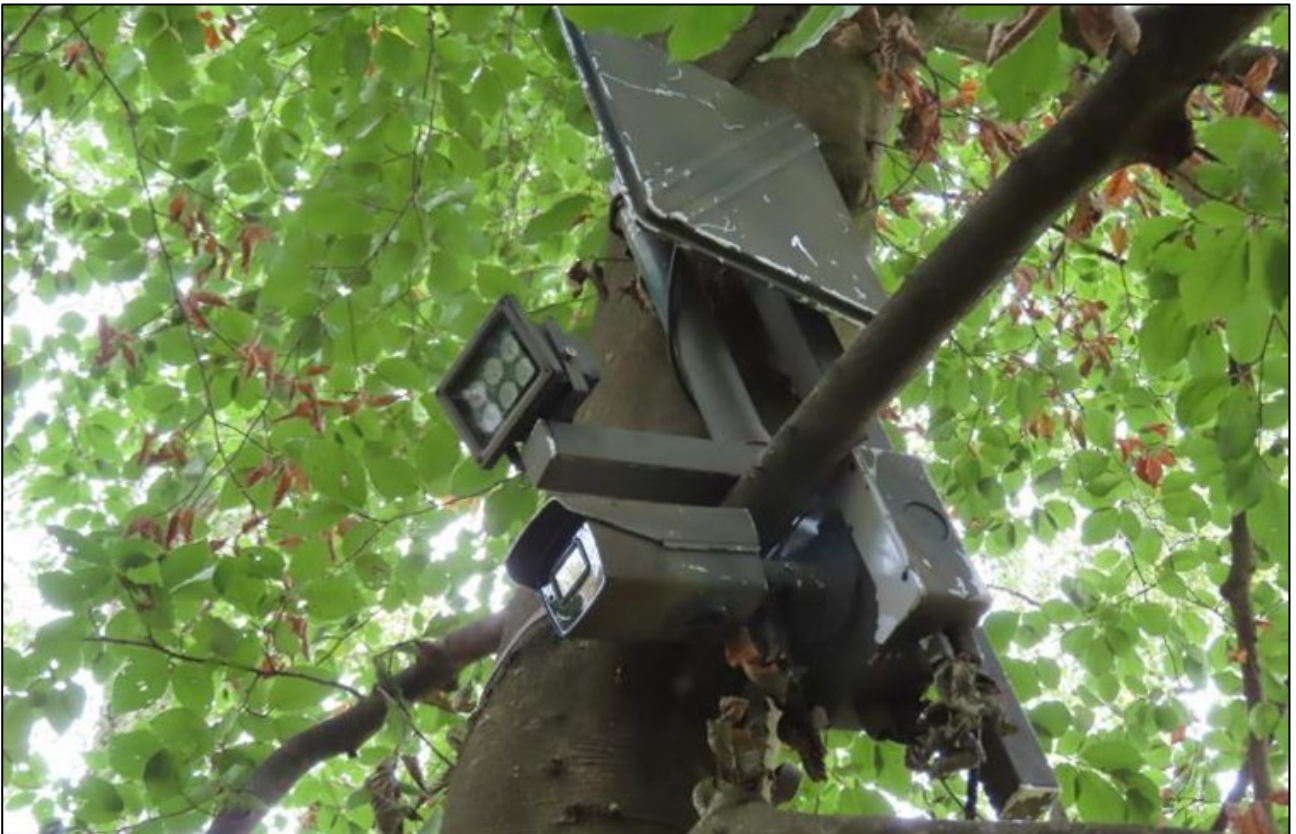
Abbildung 9: Funkbasiertes Fangüberwachungssystem mit leistungsfähiger Kamera und IR-Scheinwerfer (Foto: Dr. E. Gleich)
