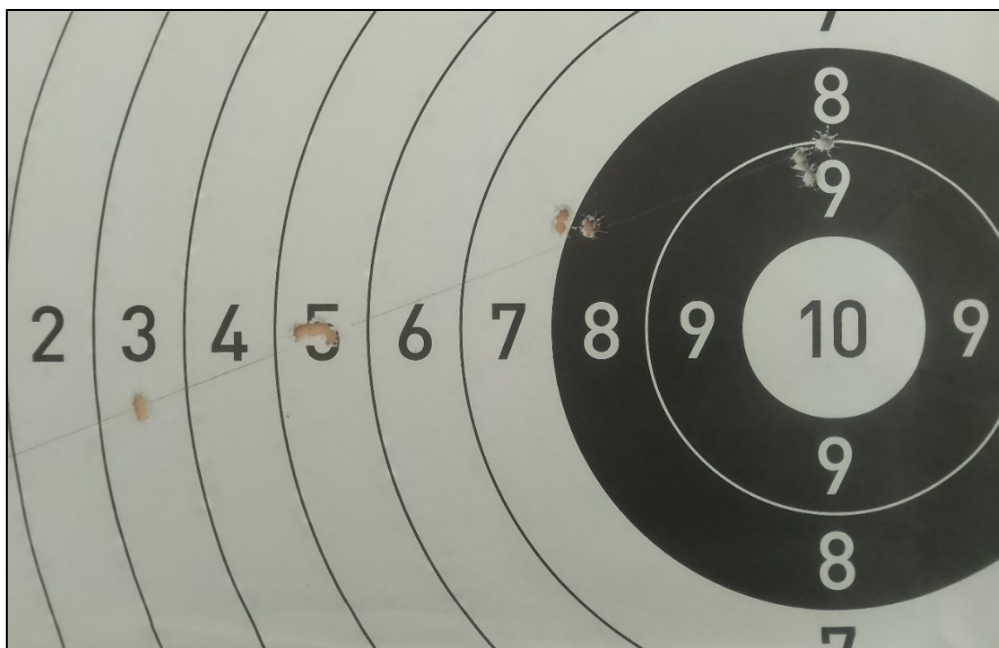
Abbildung 36: Ablage nach Schussentfernung von 3 m bis 10 m bei Fleckschuss 5 m
