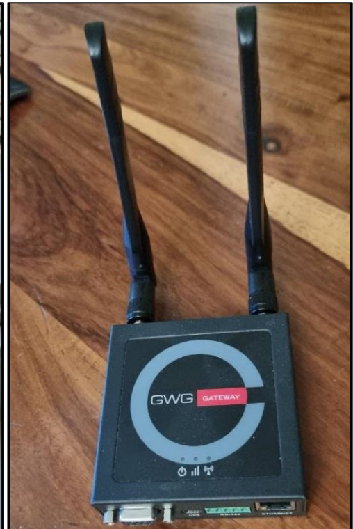
Abbildung 48: GSM-Router zum Betreiben einer LAN-Kamera (Ethernetstecker rechts). Stromversorgung über 12 Volt (Foto: Dr. J. Melzheimer)
