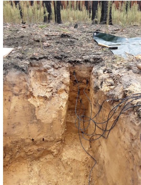
Installation von Bodenfeuchtesonden in verschiedenen Horizonten (Foto: Sophia Dobkowitz)
