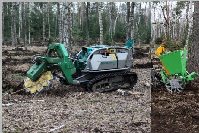
Moritz & Wildsau & Säeinheit Kleinraupe Moritz Fr50/Fr75 mit Einscheibenpflug „Wildsau P1T“ und umgebauter Säeinheit
