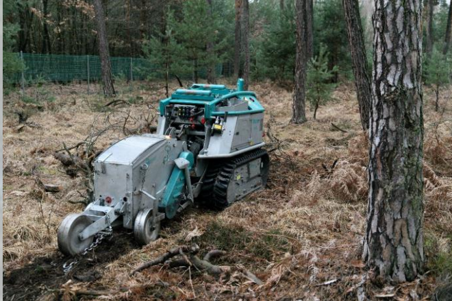
Moritz & Sä-Fräskombi Kleinraupe Moritz Fr50/Fr75 mit Sä-Streifenfräseinheit
