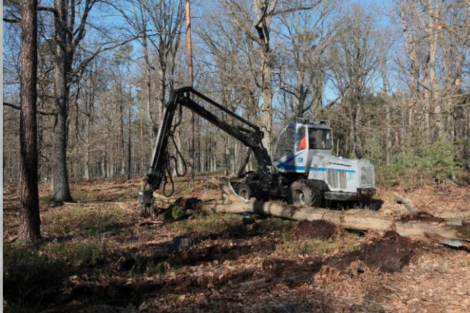
Waldbauharvester Harvester PREUSS 84 V.II mit Säeinheit Prototyp LFB, serienreif
