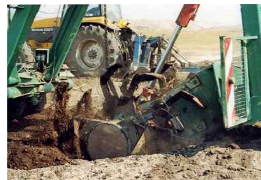
Abbildung 44: Kremer-Tiefspatenfräse KF 120 zur Einarbeitung des Meliorationskalkes auf einer forstlichen Rekultivierungsfläche im Tagebau Jänschwalde (1971-2023).
