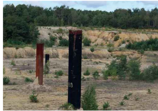
Abbildung 18: Filterbrunnenstecke des Tagebaues Klettwitz (1949-1991) zur Förderung („Sümpfung“) des Grundwassers mittels Pumpen.
