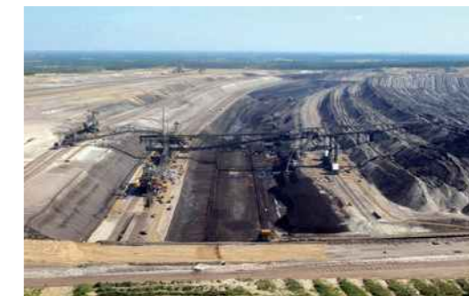
Abbildung 38: Förderbrücke F60 im Tagebau Welzow-Süd (2005), seit 1972 in Betrieb: kontinuierliche Beräumung des Deckgebirges, darunter die Arbeitsebene mit dem freigelegten Flöz.
