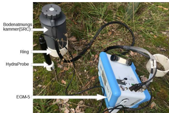
Abb. 5.3-2: Das EGM5-Instrument ist ein CO_2 -Gasanalysator und misst die vom Boden emittierte CO_2 -Menge. Ein (Kunststoff)-Ring wird dauerhaft im Boden installiert und die Bodenatmungskammer sendet den CO_2 -Ausstoß zur Messung an das EGM. Zusätzlich misst eine HydraProbe die Bodenfeuchtigkeit und -temperatur.
