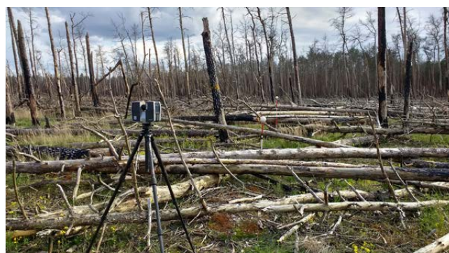
Abb. 5.5-4: Laserscanner und Referenzkugeln im Feldeinsatz
