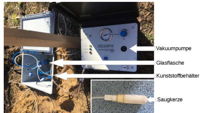
Abb. 5.3-1: Installation der Kunststoff-Box auf einem VIP-Bodenplot mit Glasflaschen an den Saugkerzen verbunden. Die Saugkerzen sind in 30, 60 und 100 cm Tiefe installiert. Die Pumpe erzeugt ein Teilvakuum in der Flasche und ermöglicht die Sammlung von Bodenlösung in verschiedenen Tiefen.
