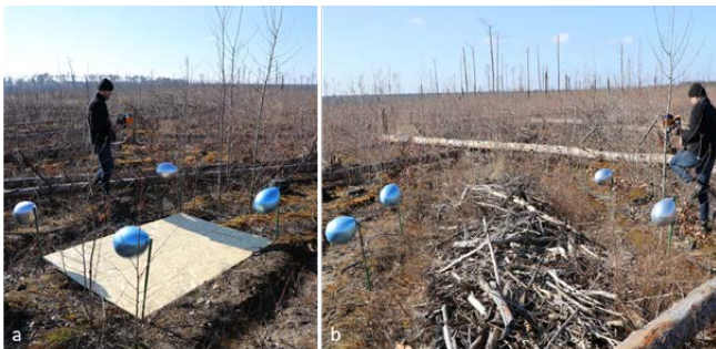
Abb. 5.5-7: mit dem mobilen Laserscanner werden erfasst a) Fläche, leere OSB-Platte und b) zwei Meter-Segment vor der Totholzentnahme (Fotos: LFB)
